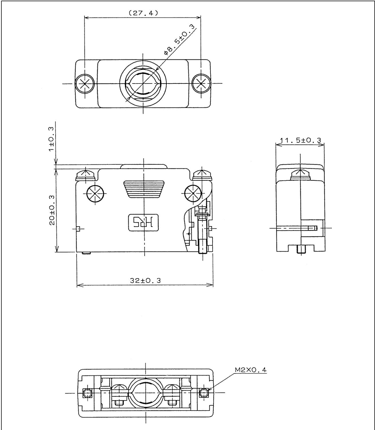
Fig. C2 (d) Connector case (PCR type (Hirose Electric))
